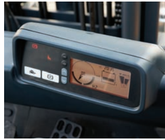
Das Display ist informativ und vollständig und für optimale Sicht ist dieses rechts auf dem Schutzbord platziert.
