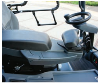
Die neue Armlehne ist solide, vollständig verstellbar und mit der sehr praktischen SOLO-PILOT Mastbedienung ausgestattet.
