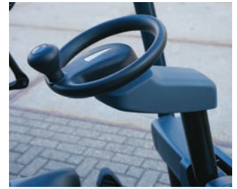
Dank des vollständig elektrischen Steuerungssystems wurde die Lenksäule beträchtlich schlanker und im Vergleich zum vorigen EFG-Modell besteht mehr Breifreiheit.
