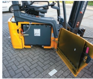
Die Scharnierkonstruktion ist robust und die Tür öffnet weit, damit man gut an die Batterie herankommt.
