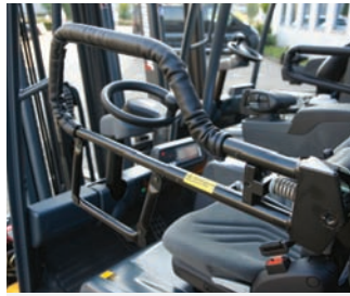
Anstelle des standardmäßigen Hüftgurtes kann auch ein Schutzgitter montiert werden, um den Fahrer bei eventuellen Zwischenfällen in der Kabine zu halten.
